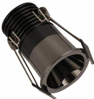
Foco empotrable LED Circular Negro cromo Perla con 6W de potencia. Con un ángulo de apertura de 40°, por lo que la iluminación es más directa para centrar la luz en puntos específicos. Fácil montaje e instalación. Bajo deslumbramiento UGR<11 y color seleccionable CCT (3000K-4000K-6000K) con un CRI>95
